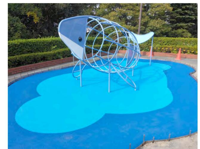
EPDMは、自動車の窓枠などに使われているゴムで、暑さや寒さ、水に強く、屋外使用時の変形・変色・劣化等の変質がおきにくい性質をもっています。色のバリエーションはお問い合わせください
